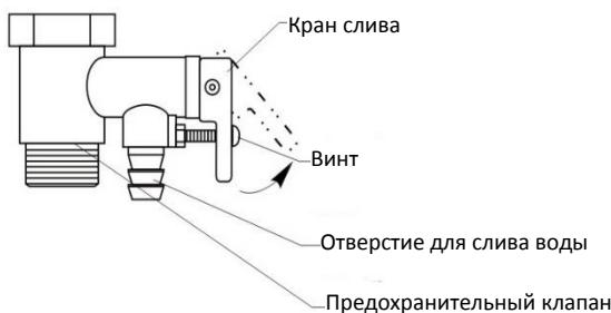
**Внимание! Между входным патрубком водонагревателя и предохранительным клапаном должно обеспечиваться соединение с постоянным полным проходом. Установка запорной арматуры (краны, вентили и т.п.) на этом участке не допускается!**
