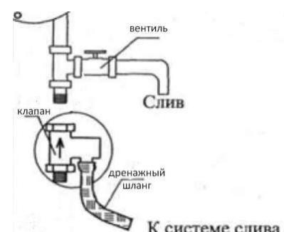
Предохранительный клапан выполняет две функции:
