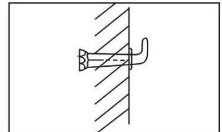
**Увага! Конструкція стіни повинна витримувати подвійну масу водонагрівача, наповненого водою.**
